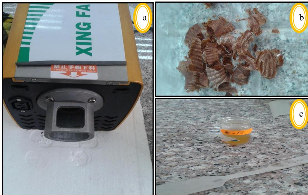
**Figure 18:** Extraction de l'huile par pression à froid. (a) : Presse à huile, (b) : Graines après macération mécanique, (c) : L'extract.
